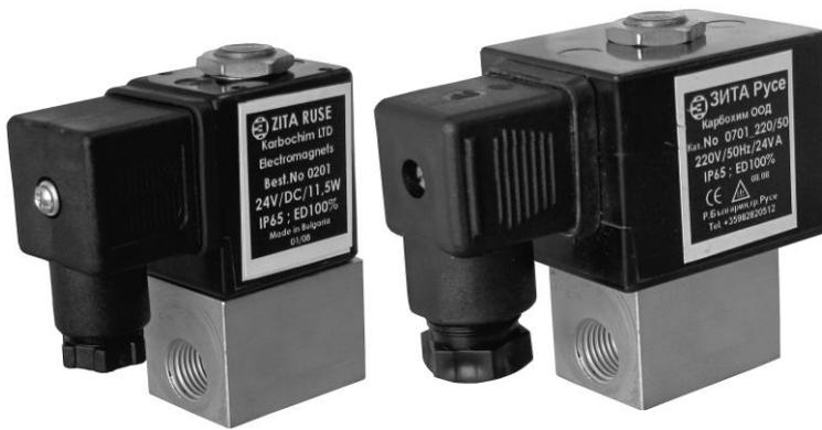
• Соленоидные клапаны это устройства, обеспечивающие с помощью электромагнитного привода протекание или остановление флуидов в трубопроводах. Они бывают директные и индиректные, нормально открыты или нормально закрыты в зависимости от их применения. Соленоидные клапаны в системе автоматического регулирования являются релейными органами для дистанционного
